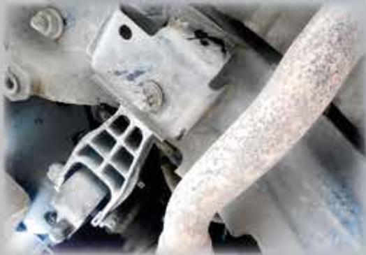
1. Identificar el soporte de motor dañado a reemplazar y todos los componentes a desinstalar durante el proceso.
