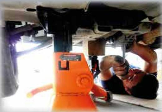
3. Colocarse justo abajo del motor para aflojar los tornillos del soporte. En ocasiones sera necesario utilizar una extension larga o conexiones universales.
